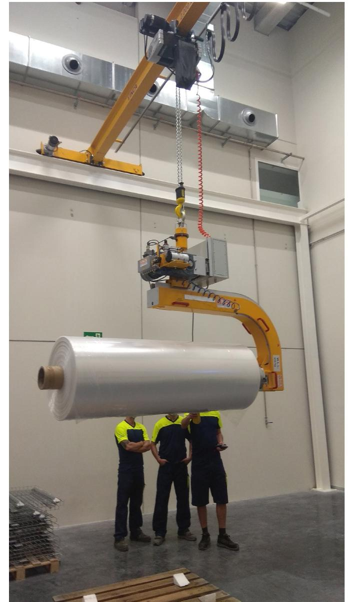
**Puente grúa y volteador para bobinas grandes**
