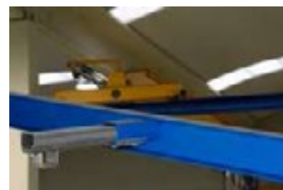
SOPORTES SOLDABLES A VIGA
