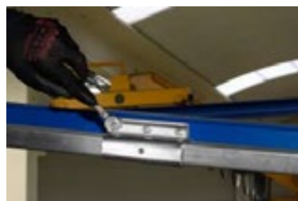
Instalar el primer perfil en los soportes sin apretar la tornillería de dichos soportes 2500-4.
