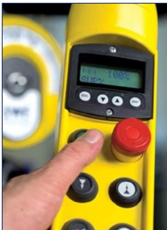
El NovaMaster garantiza maniobras de elevación y parada suaves, protegiendo así los componentes mecánicos y el sistema de frenos. Durante los movimientos de frenado y aceleración, el sistema se sitúa en el nivel más bajo de velocidad para no sobrecargar el sistema de frenado. En todo momento se realiza una monitorización del período de trabajo seguro (SWP).
