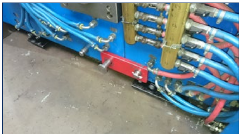
Foto 2. Seguro de bloqueo entre las 2 partes del molde.
