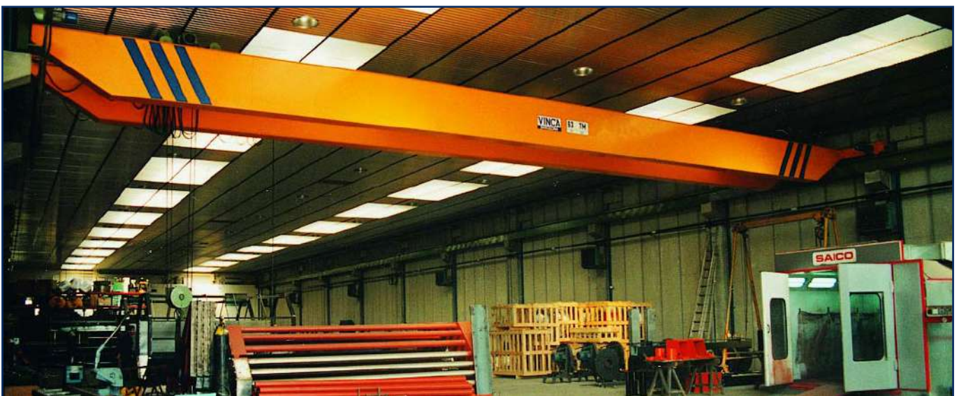
Cilindros de hasta 25 Tm. de peso, son manipulados con precisión y seguridad con la Grúa Birraíl VINCA.
