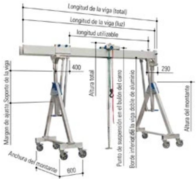
La grúa de pórtico de aluminio está equipada dos ambos lados con una traviesa entre el montante y la viga doble de aluminio. Esta conexión dota a la grúa de pórtico de aluminio con una estabilidad adicional.
