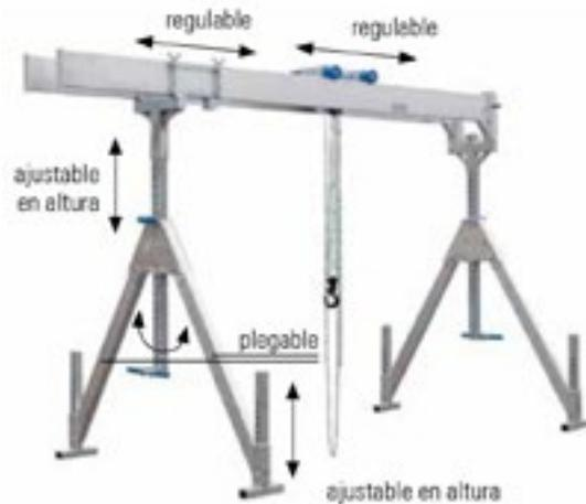
El sistema de grúa de pórtico de aluminio es una construcción autoestable, muy móvil, flexible y ajustable tanto en altura como en longitud.
