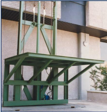
Plataforma básica, de un solo mástil (sin puertas de acceso y sin protecciones perimetrales). Se muestra solo a efectos informativos.
