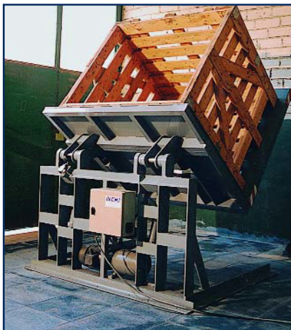
Volteador en funcionamiento para "palots" (cestones de madera normalizados).
