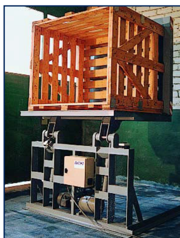
Volteador en funcionamiento para "palots" (cestones de madera normalizados).
