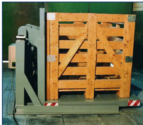
Volteador en funcionamiento para "palots" (cestones de madera normalizados).
