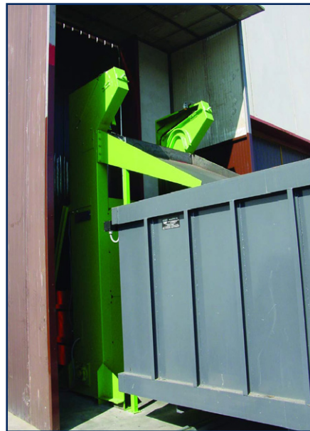
SKIPS para vaciado de recorte de chapa a container, desde interior de nave a patio adyacente.
