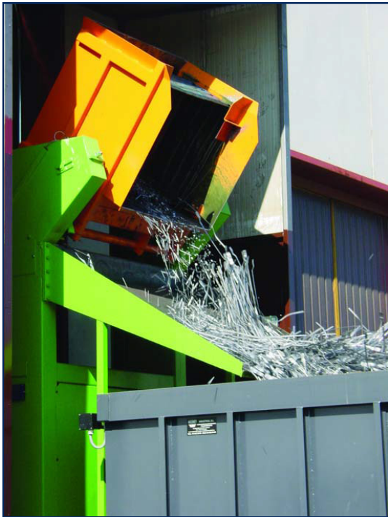
SKIPS para vaciado de recorte de chapa a container, desde interior de nave a patio adyacente.
